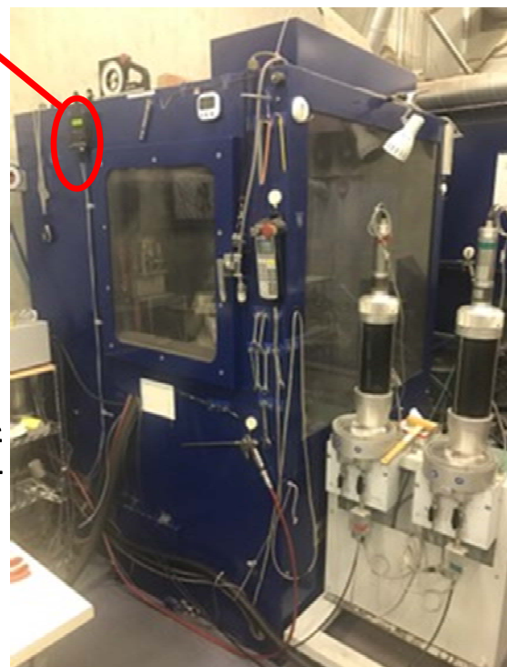
モニター付きパウダーセンサー 設置例 コールドスプレー用スプレーブース
