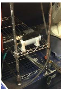
ブース内に設置した パウダーセンサー
