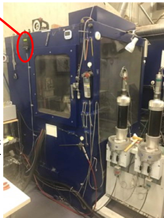
モニター付きパウダーセンサー 設置例 コールドスプレー用スプレーブース
