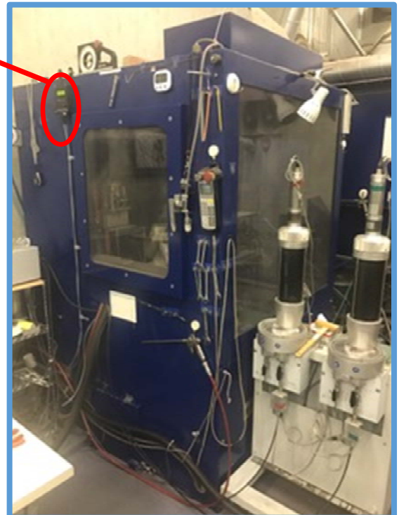
モニター付きパウダーセンサー 設置例 コールドスプレー用ブース
