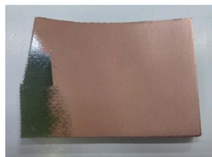
基材:FRP厚板、粉末:銅 厚さ10~30 \mu m
