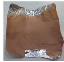
基材:アルミフویل、 粉末:銅、錫(Sn) 厚さ10~20 \mu m
