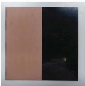
基材:EMS製 高機能 ポリアミド板 100x100x2t 粉末:銅、厚さ10~30 \mu m
