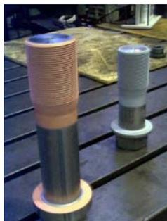
銅、亜鉛コーティングによるねじ山補強
