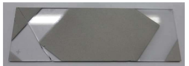
基材:ガラス 粉末:錫(Sn) 厚さ10~30 \mu m
