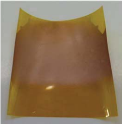
基材:ポリイミドフィルム (Kapton) 25 \mu m 粉末:銅、錫(Sn)等 厚さ約 5 \mu m
