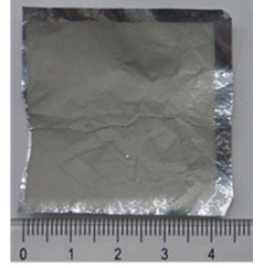
基材:アルミフویل、 粉末:銅、錫 (Sn) 厚さ10~20 \mu m
