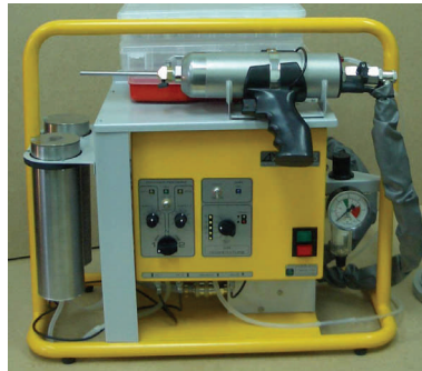
ポータブル型 DYMET 413 (圧縮空気・窒素ガス 550°C 1MPa以下)
