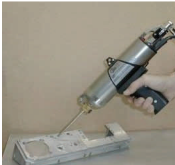
ポータブル型 DYMET 413 (圧縮空気・窒素ガス 550°C 1MPa以下)
